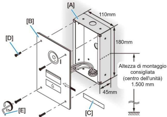
**1 Installare l'involucro posteriore montaggio a parete [A] nella parete.**
